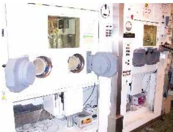
Stoppeltüren Pb 60mm Heiße Zelle zu PET-Zyklotron
